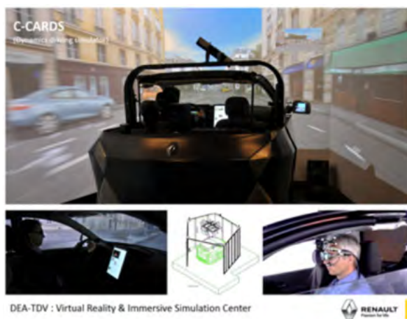
Figure 1 : C-CARDS : Simulateur de conduite dynamique chez Renault
