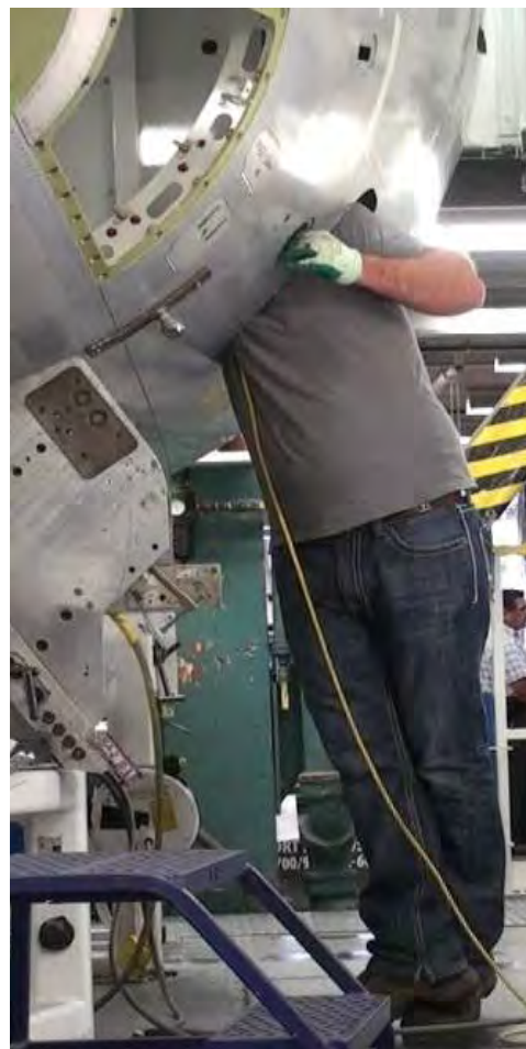
Rivetage à l'intérieur d'une cavité ( access hole )
